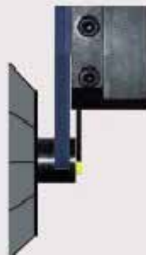
Si fa avanzare il PULLEX un poco oltre il centro della barra per afferrare la barra
